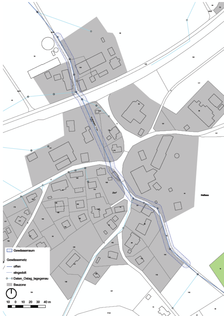
Abb. 1 Gewässerverlauf Eindolung Grabebach
